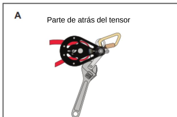
FIGURA 8 - REDUCCIÓN DE LA TENSIÓN DE LA LÍNEA SALVAVIDAS
